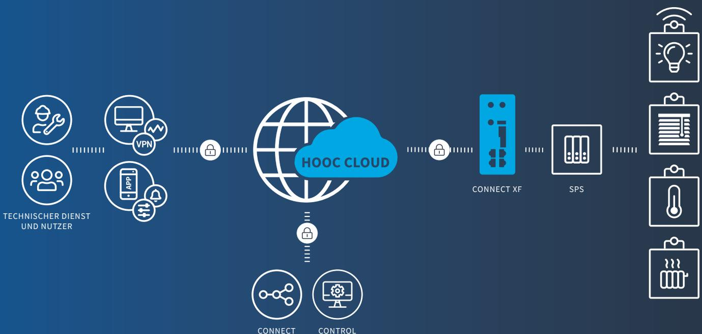
**Im Detail** (von links nach rechts): Der Anwender (technische Verantwortliche, Operator, Endkunde u.Ä.) loggt sich via App oder PC ein und erhält über eine gesicherte Verbindung Zugang zur HOOC Cloud. Von hier aus kann er dank des HOOC-Gateways auf seine verschiedenen IT-Systeme, HLK-Anlagen oder Smart-Home-Anwendungen zugreifen. Dieser hochsichere VPN-Tunnel bildet die Basis für alle weiteren HOOC-Lösungen im Bereich Connect, Control und Collab.
